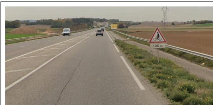
Figure 60 : Exemple d'indice faisant croire à un cheminement cycle : signalisation verticale et bande bitumée séparée (source : Google Maps)
