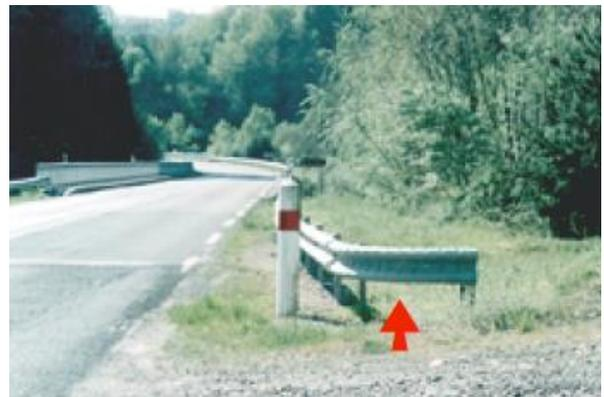
Figure 50 : Extrémité de dispositif de retenue constituant un obstacle (Source : Cerema)
