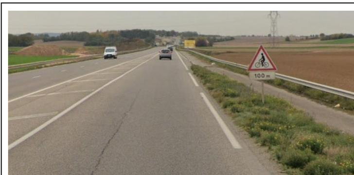
Figure 58 : Exemple d'indice faisant croire à un cheminement cycle : signalisation verticale et bande bitumée séparée (source : Google Maps)
